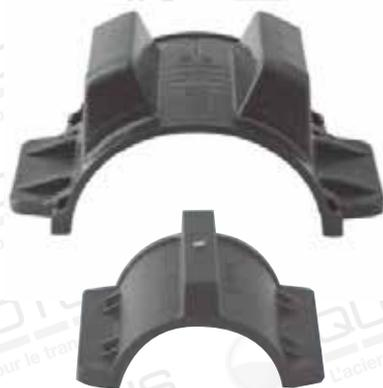
Les centreurs à patins modèle PA/PE sont livrables pour diamètres extérieurs de tubes de 25 mm à 336 mm. Ils consistent en deux demi-coquilles. Les vis et écrous nécessaires au montage sont inclus dans chaque livraison.
